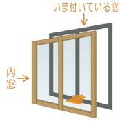
今ある窓に内窓を取り付けることで 2つの窓の間に空気層が生まれます。 既存の窓 これが壁の役割となり、 断熱効果や防音効果を生み出します。
