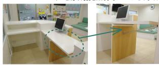
▲通路部分には跳ね上げ天板を設置し、 パソコン横の作業台の延長として利用できます。
